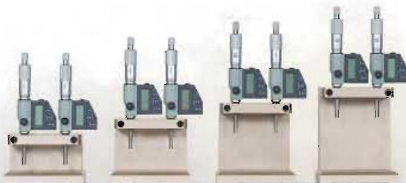
I tiratori che ricaricano le proprie munizioni dovrebbero controllare la C.O.L. (Cartridge over all length) ovvero la lunghezza complessiva di tutte le cartucce. I nostri calibri passa - non passa permettono di controllare la C.O.L. di tutte le munizioni in tempi molto piu' brevi e con grande precisione. Questo metodo di controllo industriale è certo tanto da garantire una determinata misura entro una tolleranza di piu' o meno un decimo di mm ( $\pm 0,1$  mm).
